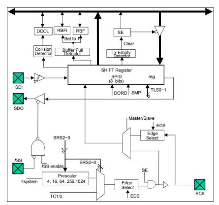
Fig. 5-13 SPI Block Diagram
